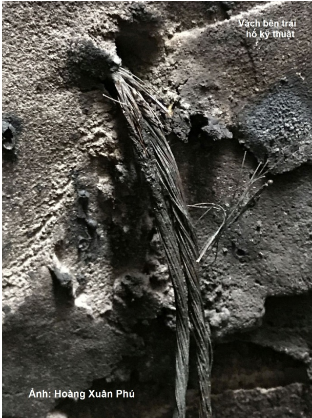
Ảnh 3.7: Lõi cáp đã bị cháy hết hai lớp cách điện.
