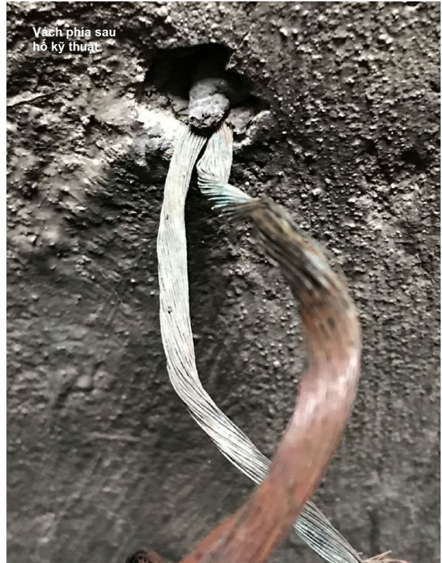
Ảnh 3.7: Lõi cáp đã bị cháy hết hai lớp cách điện.
